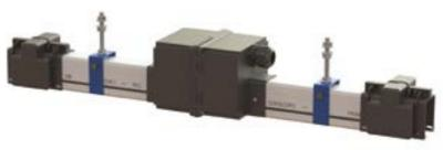
Conjunto formado por una caja de acometida intermedia con un prensaestopas M25x1,5, dos tramos de barra conductora de 300mm cada uno, dos punto fijos RGMM05, así como dos empalmes de línea RGMM02.
